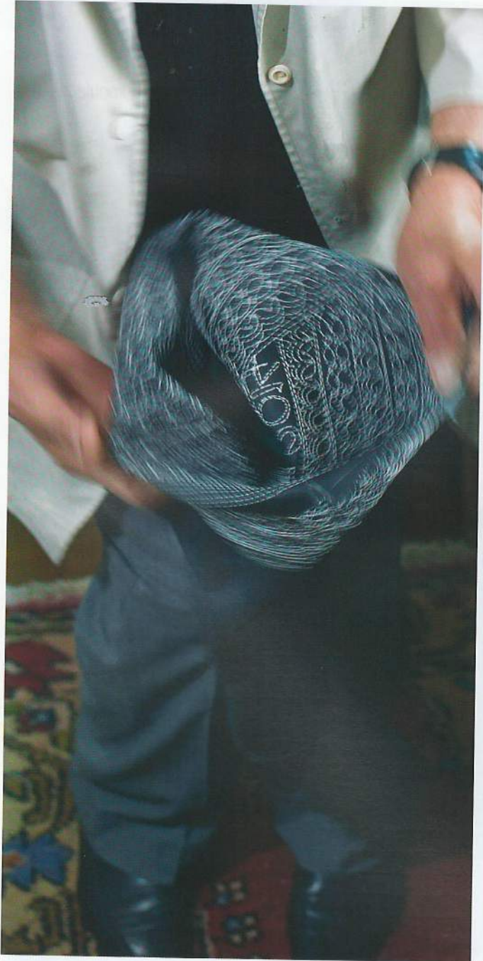
Bacağın ters yüz edilmesi işlemi
