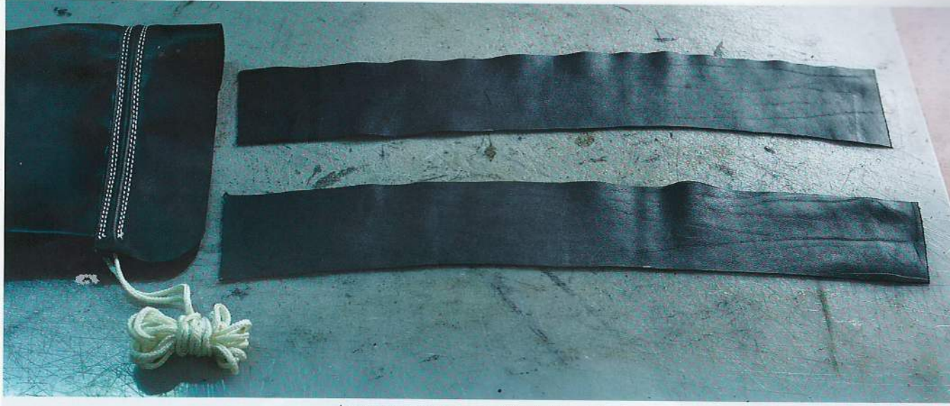
İki sıra dikiş atma ve paça ipi yerleştirme işlemi
