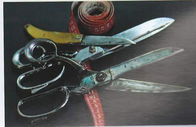
Kıspet Yapımında Kullanılan Araçlar (Makas, Biz, Bıçak)
