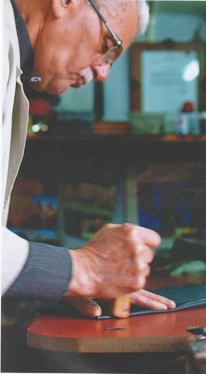
Istaka ile bacağın ortasını belirleme işlemi
