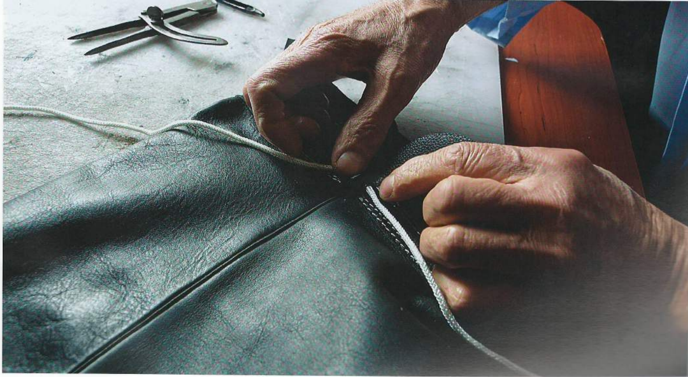
İki sıra dikiş atma ve paça ipi yerleştirme işlemi
